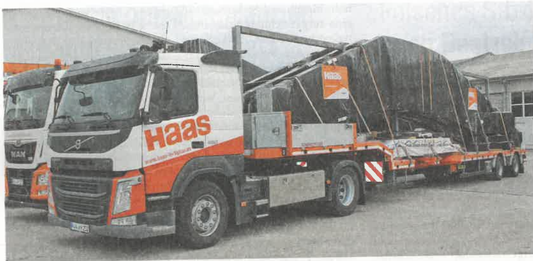
Fertig zum Abtransport: Vorgefertigte Bauteile von der Haas Fertigbau GmbH – wie hier für eine große Halle – werden kompakt und geschützt verpackt per Lkw zum Zielort gefahren. Foto: Süß
