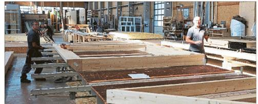
Rahmen aus Fichtenholz werden in den Werken der Fertighaushersteller zu Hauswänden verarbeitet. Je nach Größe der Werke kommt dabei mehr oder weniger Handarbeit zum Einsatz. Fotos: ker
