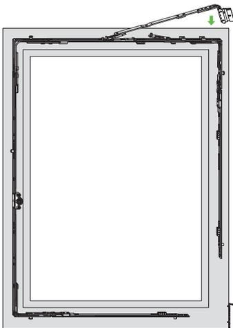
Die Kippweitenbegrenzung ermöglicht eine variierbare Lüftungsstellung. Dies kann jedoch nur vom Fachpersonal durchgeführt werden!
