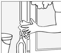
Mit einem gut saugenden, farbneutralen Tuch (Wolle, Baumwolle oder Zellstoff) den Reiniger möglichst entlang der Längsrichtung der Profile auftragen und
