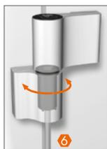
Lagerbuchse um +/- 90° drehen bis sie spürbar einrastet. (Dichtungsdruck +/- 0,5mm)
