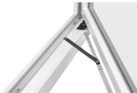
Die Feststellschere begrenzt den Öffnungswinkel des Drehflügels auf 90° (bis 90° ist der Öffnungswinkel frei wählbar). Sie verhindert die selbstständige Bewegung des Elementflügels bei Zugluft.
