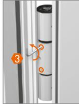
Gewindestifte mit einer 1/2-Umdrehung lösen.
