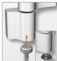
Hebespindel wieder einschrauben. Kappe aufsetzen.
