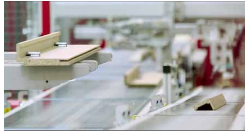
Die Zargenfertigung hat Grauthoff 2014 am Stammsitz in Rietberg-Mastholte in den Gebäuden des ehemaligen Möbelherstellers Driftmeier konzentriert. Links vorne im Bild ist ein Futterbrett mit bereits angeschraubten Bandtaschen zu sehen. Rechts auf dem Band läuft die Zierbekleidung heran, die im nächsten Fertigungsschritt mit dem Futterbrett zusammengeführt wird.
